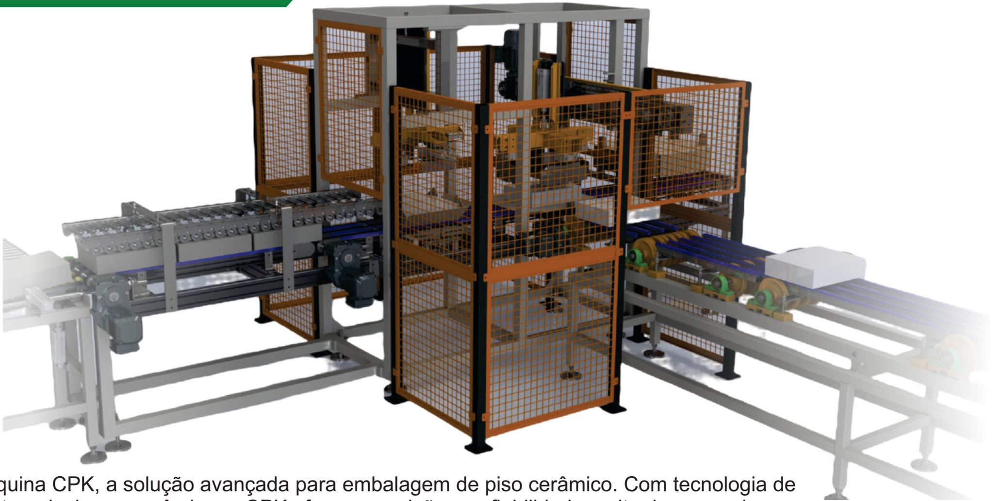
Máquina CPK, a solução avançada para embalagem de piso cerâmico. Com tecnologia de ponta e design ergonômico, a CPK oferece precisão, confiabilidade e alto desempenho. Sua capacidade de embalar diferentes tamanhos e formatos de pisos cerâmicos, aliada à programação personalizada, garante flexibilidade. Automatizada e eficiente, O CPK aumenta a velocidade de embalagem, economizando tempo e recursos. Uma solução completa para elevar a qualidade da produção cerâmica
