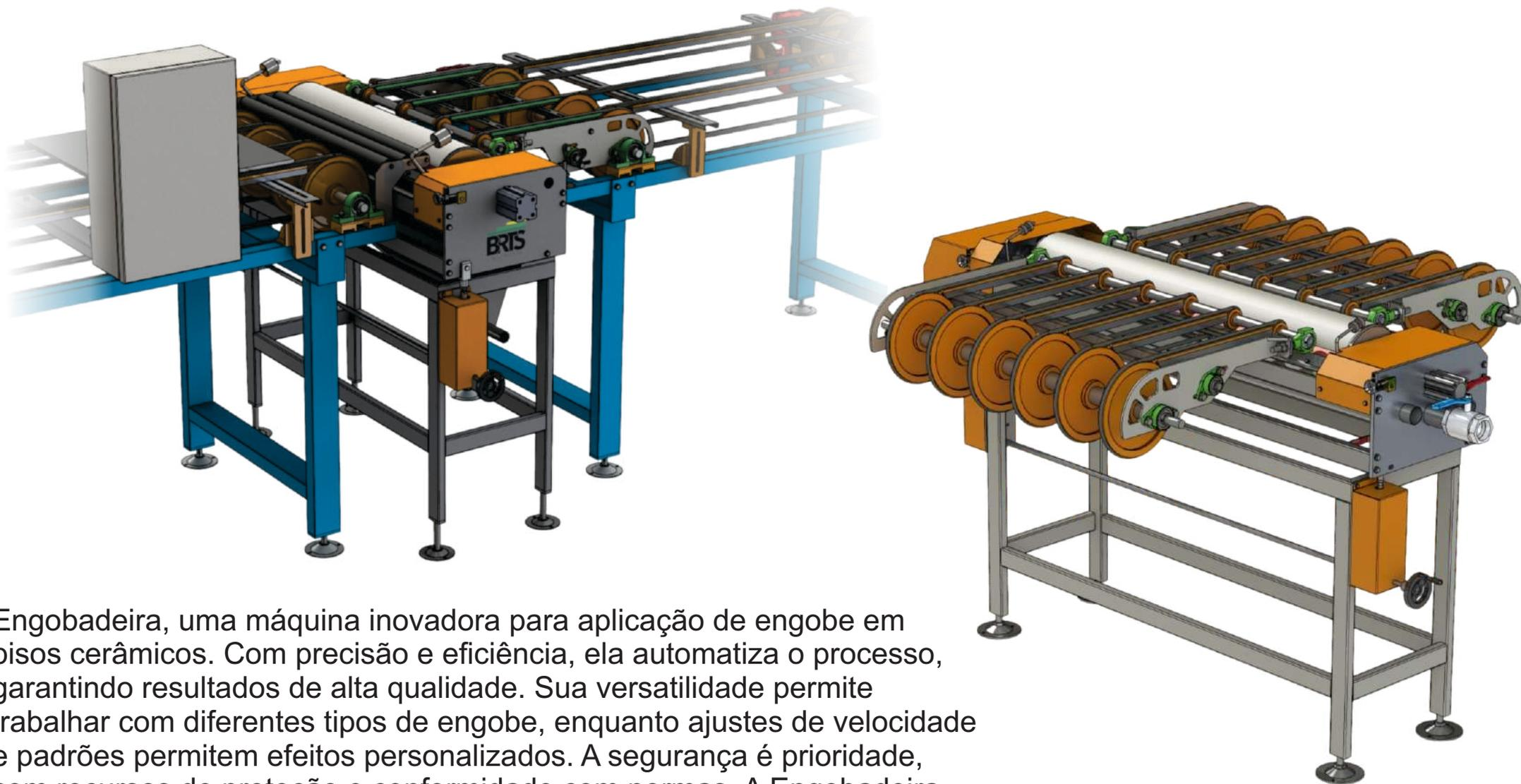
Engobadeira, uma máquina inovadora para aplicação de engobe em pisos cerâmicos. Com precisão e eficiência, ela automatiza o processo, garantindo resultados de alta qualidade. Sua versatilidade permite trabalhar com diferentes tipos de engobe, enquanto ajustes de velocidade e padrões permitem efeitos personalizados. A segurança é prioridade, com recursos de proteção e conformidade com normas. A Engobadeira aumenta a produtividade, reduz custos e oferece maior eficiência no uso de materiais.
